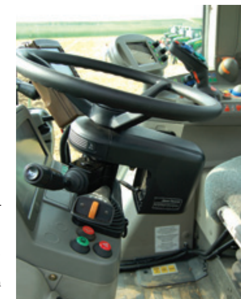
Voorop de stuurkolom zit een lange strip. Wanneer je deze indrukt, wordt het stuur geactiveerd.
