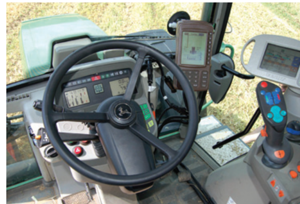
Het Universal stuur-tje is binnen een kwartier over te plaatsen van de ene naar de andere trekker of maaidorser.
