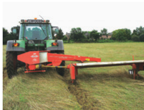
Bij de graszaadteelt geeft een breed zwad minder zaadverlies. De meeste graszaadmaaiers zijn zelfrijders. Van der Woerd maait met een front- en achtermaaier. De maaidorser raapt drie zwaden op.
