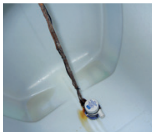
De vorm van de tank is niet goed. De buitenste delen van de tank liggen lager dan de afvoer in het midden.
