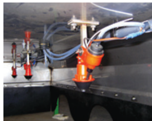
Boven elke rug is een schijfvernevelaar gemonteerd. De vier vernevelaars zorgen voor een volvelds nevel.
