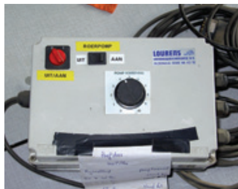
Vanuit de trekker kan met de bedieningskast de afgifte worden ingesteld.
