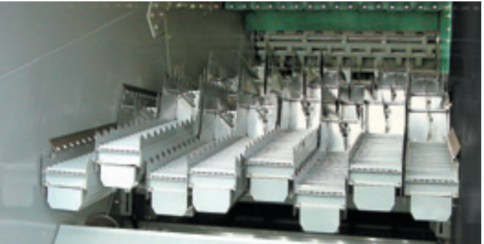
Acht schudders in de MF Cerea zorgen voor een ongeveer 33 procent grotere capaciteit dan een zesschudder.
