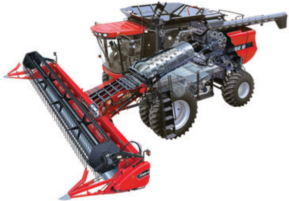
Probleem van conventionele machines met meer schudders is de grote hoeveelheid stro. Een andere afscheidingsprincipe, het axiaaldorsen, heeft daar geen last van. Het stro wordt in de lange afscheidingstrommel behoorlijk kort geslagen. De korrelbeschadiging bij de Case IH Axial Flow is minimaal en er is minder korrelverlies bij grotere rijnsnelheid.
