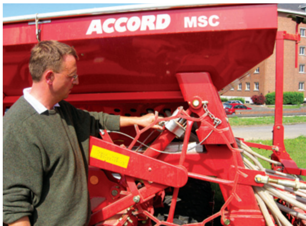
Harold Grandjean, werkzaam bij het Belgisch landbouwinstituut CRA-W, wijst naar de mechanische instelling van de zaaidiepte van de Accord MSC. "De machine kan tot 10 cm diep zaaien. Groot voordeel van de MSC is de werksnelheid, zowel over stoppel als geploegd land. Wel heb je een grote kopakker nodig om te draaien. Opbrengstverschil met conventionele methoden hebben we niet gemerkt."
