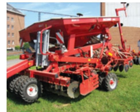
In transportstand en op de kopakker rijdt de zaaimachine op een rij wielen die ook als rijenpakker functioneren.
