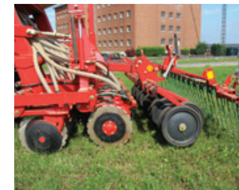
Het zaaigedeelte met 24 schijfkouters die op druk worden gehouden door een bladveer voor een constante zaaidiepte. Elke kouter heeft steenbeveiliging.
