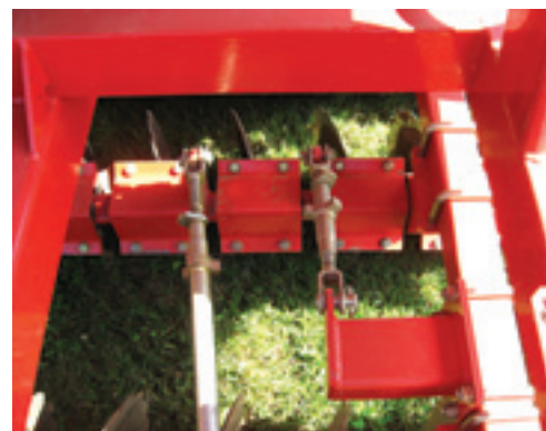
De draaistang voor de diepte in te stellen van de schijveneg is lastig bereikbaar. Een hydraulische verstelling is optioneel leverbaar.
