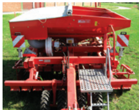
Vanuit de cabine kun je het resultaat van de grondbewerking en het zaaien slecht zien. Aan de voorzijde van machine bevindt zich een inklapbaar trapje.
