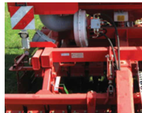
Rechtsboven op de foto bevindt zich de centrale hydrauliekpomp. De meter beneden geeft de diepte van de schijveneg weer.
