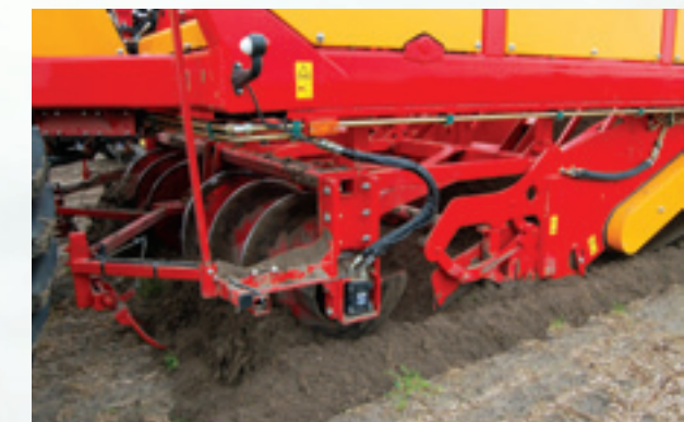
De vijzel haalt de bovenste laag grond van het bed, waarna een trillende rooibek de bollen omhoog brengt.
