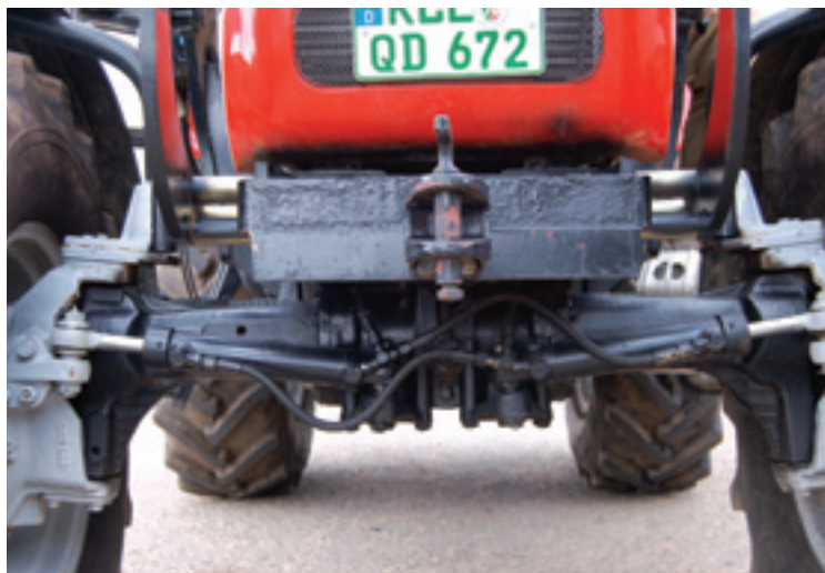
De met 10,6 meter niet bepaald krap draaiende vooras gebruikt twee stuurcilinders.
