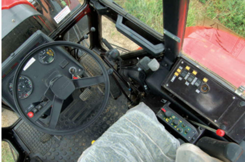
De cabine blinkt niet uit qua ergonomie. De hendels staan heel dicht bij elkaar. Opvallend is dat het stuur uit het midden staat.
