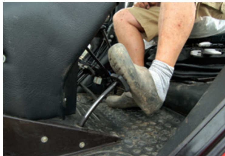
De versnellingspook schakelt als een mes door de boter. De koppeling zit hoog, is zwaar en moeilijk te doseren.
