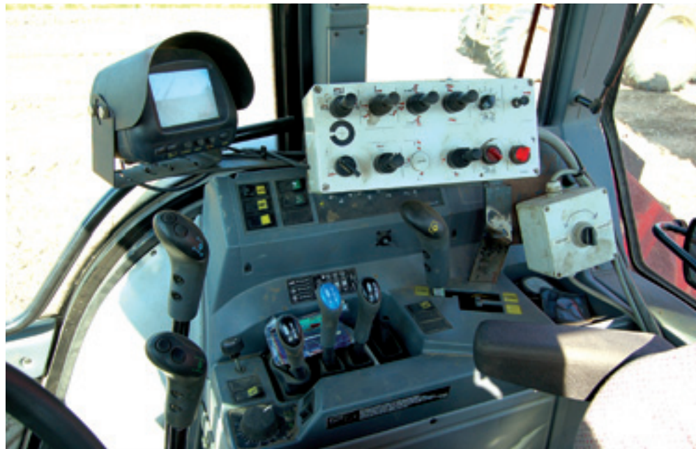
Naast de beide schakelpoken met knoppen de drie hendels voor de hydrauliek. Boven de poken een TV-scherm in het circuit met twee camera's op de rooimachine.
