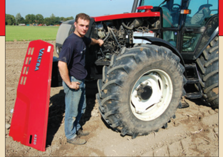
Voor het bijvullen en controle van het luchtfilter moet de zijplaat worden verwijderd. Voor de controle van het oliepeil is dat niet nodig.
