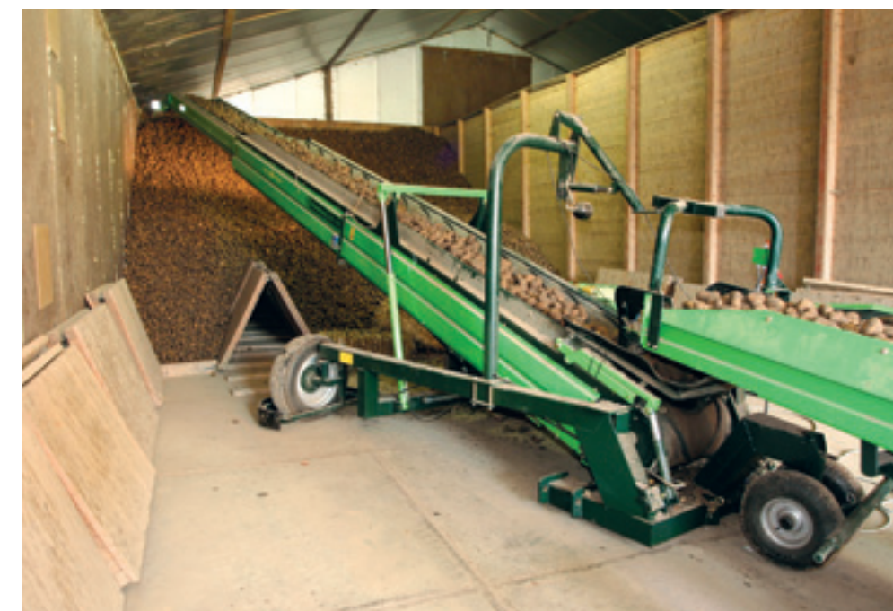
De storthoogte verlagen doordat je veel doorwas hebt, werkt nadelig voor de beluchting als je de bovengrondse kanalen niet dicht bij elkaar zet. De afstand tussen twee kanalen moet 0,8 maal de storthoogte zijn.
