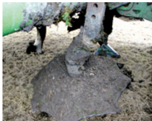
De spitmachine wordt op diepte gehouden door gekartelde schijven die diagonaal over de grond slepen. Dit is een beter alternatief dan wielen, omdat deze sneller slijten en bovendien een kleiner contactoppervlak met de grond hebben.
