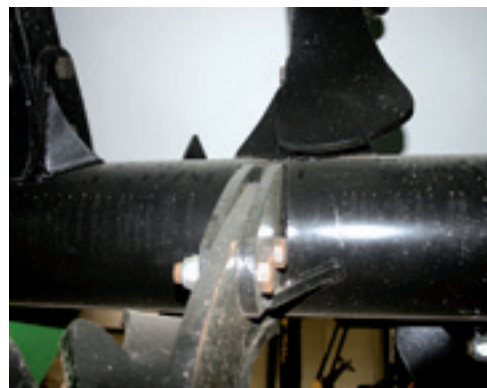
De 'spaden' zijn met bouten op de rotor gemonteerd zodat ze eenvoudig zijn te vervangen.
