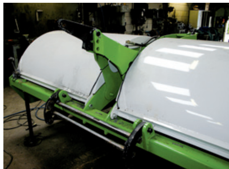
Je kunt ook een aftakasaangedreven werktuig achter de spitmachine hangen. Hiervoor is een bok achterop gemonteerd. Onder de aanspanning van de topstang zit een cilinder waarmee je het werktuig kunt laten heffen en dalen.
