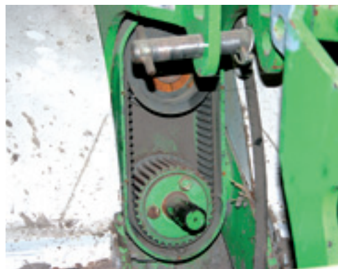
Werd voorheen de aftakas achter de spitmachine aangedreven door een getande V-snaar die rechtstreeks werd afgetakt van de stomp voorop de spitmachine, tegenwoordig is deze V-snaar vervangen door een tandwiel. Dit is minder storingsgevoelig gebleken in de praktijk.
