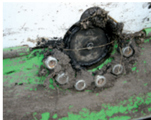
Om de rotor te verwijderen hoeft je enkel aan beide kanten zes bouten los te draaien en de rotor iets te verdraaien.
