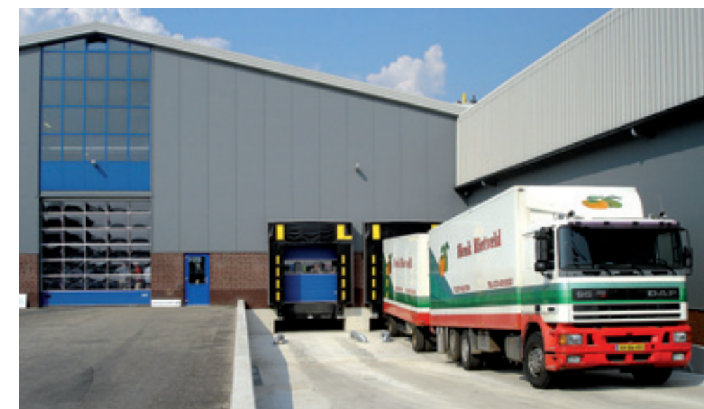
Waar de laadkuil al gewoon is in de fruitteelt, bloembollensector en glastuinbouw, kiezen ook steeds meer akkerbouwers en vollegrondsgroentetelers bij nieuwbouw voor een laad- en loskuil. Hierdoor kan de vrachtwagenchauffeur sneller en zelf product laden met een heftruck. Ook bij een vrachtauto zonder laadklep.
