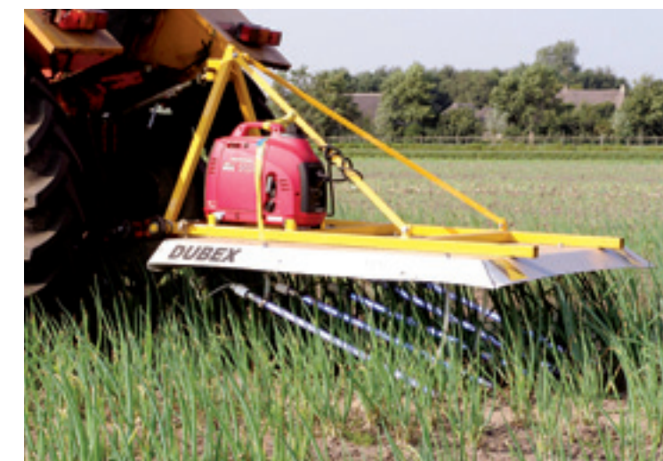
De Cleanlight van Dubex. De energie van de lampen doodt bacteriën en schimmels.
