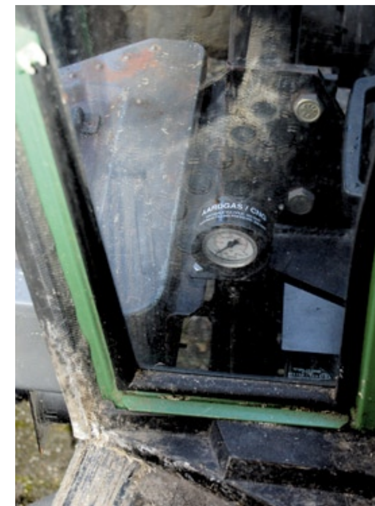
▲ De manometer op het reduceerblok is zichtbaar vanuit de cabine.
