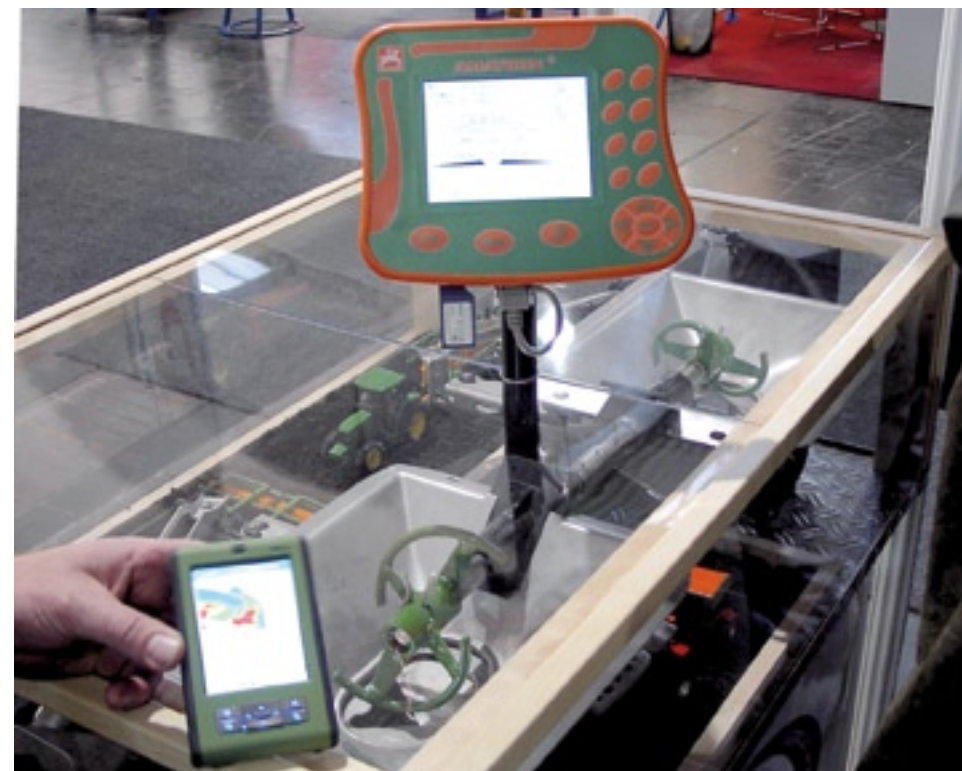
▲ Door Bluetooth zijn PDA en terminal eenvoudig te koppelen.
