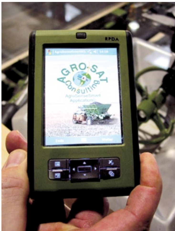
▲ Voorbeeld van een eenvoudige RPDA (waterdichte Rugged PDA).
