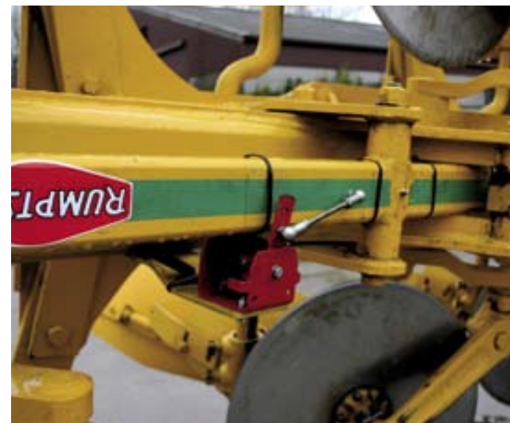
▲ Om te kunnen varioploegen wordt een sensor op de ploeg geplaatst, deze meet voortdurend de ploegbreedte, via een elektrohydraulisch ventiel wordt deze zonodig aangepast.
