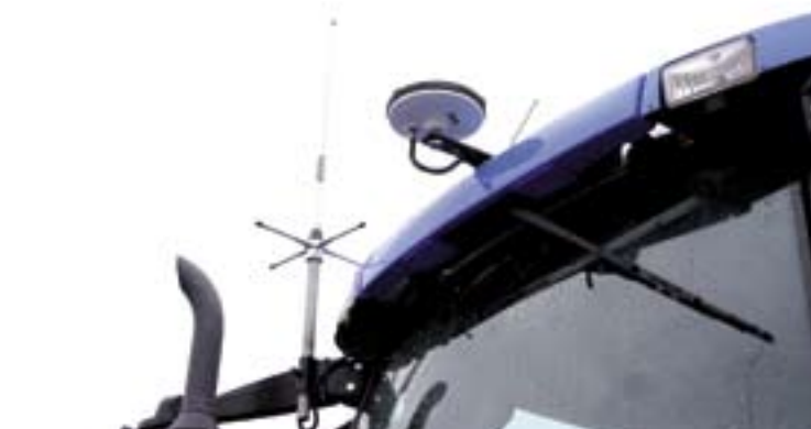
▲ De twee ontvangers waar het allemaal om draait: links de RTK-ontvanger en rechts de GPS-ontvanger.
