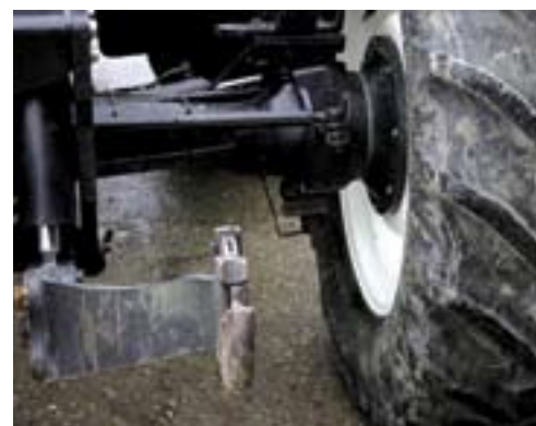
▲ Voor het gebruik van automatische trekkerbesturing wordt een stuurhoeksensor op de vooras geplaatst. Deze meet de wieluitslag en geeft dit signaal door aan de sturelektronica.
