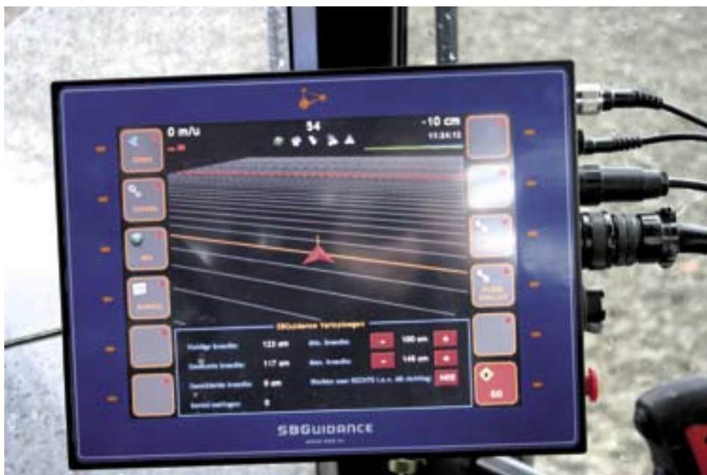
▲ De bedieningskast van SBG: fors aan de maat, maar alle elektronica zit er in.
