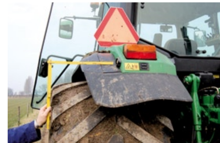
▲ Te hoog en te ver van de zijkant, een probleem bij verlichting en markering op grote trekkers op brede banden.
