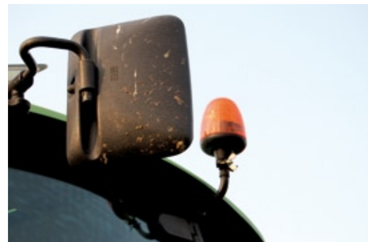
▲ Uitschuifbare spiegel en zwaailicht zijn op zware trekkers bijna altijd verplicht.
