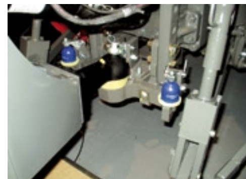
▲ Een populaire oplossing in het loonwerk is de combinatie van een 80 mm kogel voor het trekwerk met één of twee 50 mm kogels voor het regelen van de gedwongen besturing.
