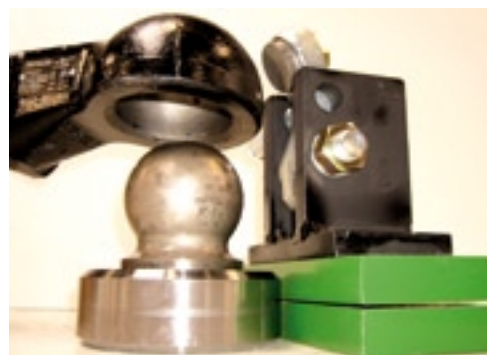
▲ Een kogel, een werktuigdeel en een vergrendeling: meer is er niet nodig voor maximale bewegingsvrijheid en minimale speling. Bij regelmatig smeren is de slijtage gering.
