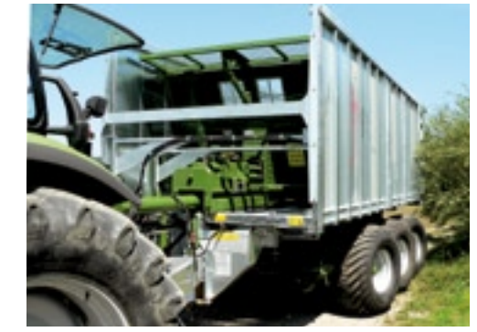
▲ In de Premium-versie kan het onderstel van Fliegl zowel traditioneel een bocht maken (voor- en achteras tegengesteld) als met alle zes wielen in dezelfde richting.
