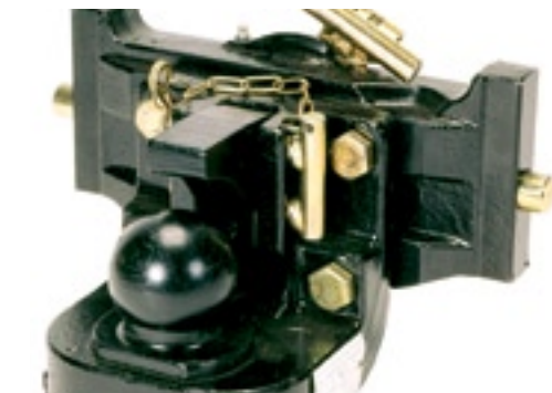
▲ Deze kogel van Sauermann past in de geleiding van de snelverstel-trekhaak en vervangt daar dus probleemloos de standaardtrekhaak. Dat vergemakkelijkt de overstap.
