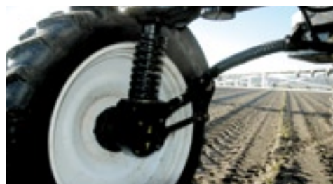
▲ De aandrijving op de voorwielen is hydrostatisch en op de achterwielen mechanisch.
