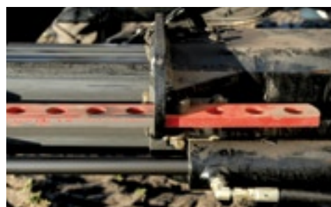
▲ De hydraulische spoorbreedteverstelling is in principe traploos, maar werkt getrapt.
