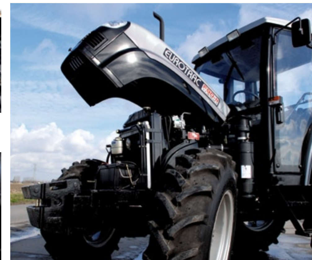
▲ Onder de motorkap ligt een viencilindermotor van Chinese makelij. Bovenop de krachtbron is ook de motor van de airco gemonteerd. Om de koelers te verwijderen heb je moersleutels nodig.
