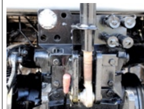
▲ De trekker is voorzien van twee dubbelwerkende hydraulische aansluitingen.
