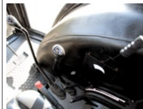
▲ De Eurotrac F90 II heeft twaalf versnellingen vooruit verdeeld over drie groepen.
