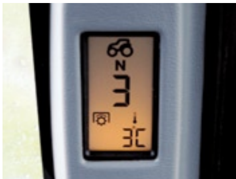
▲ Het display in de rechter A-stijl toont onder meer de stand van de transmissie en aftakas.
