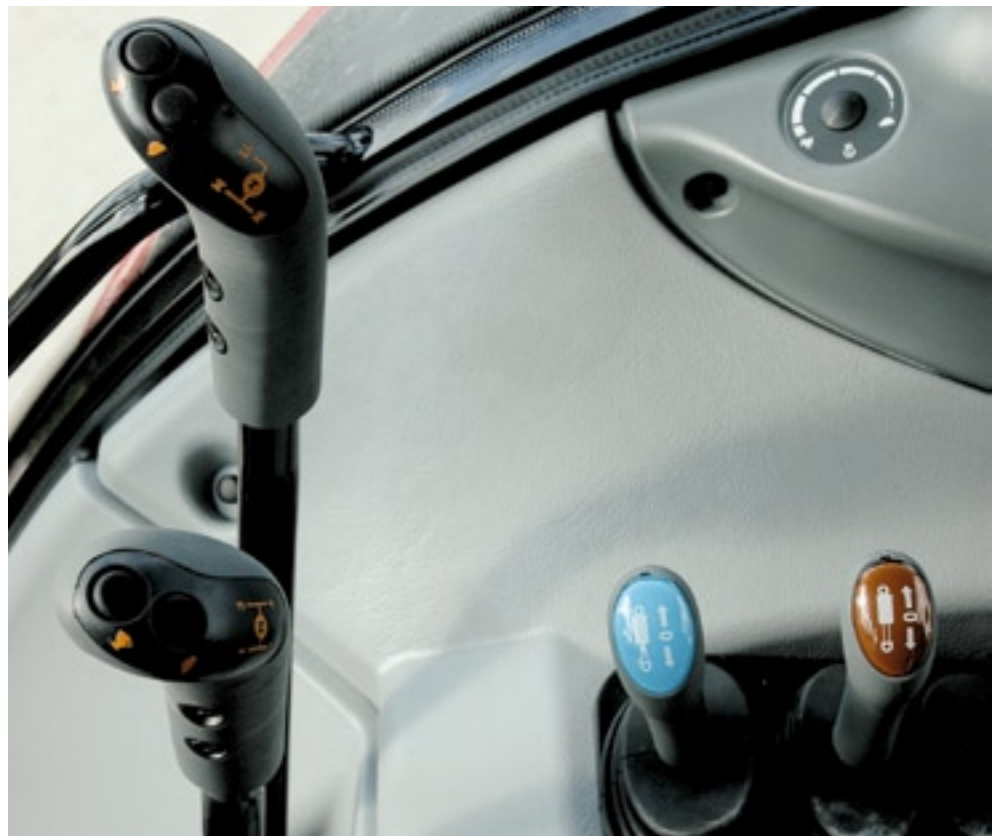
▲ De beide poken (vier versnellingen, drie groepen) schakelen samen met de drietraps powershift 36+36 mogelijkheden. De hydrauliek heeft standaard twee mechanische EW/DW-ventielen.
