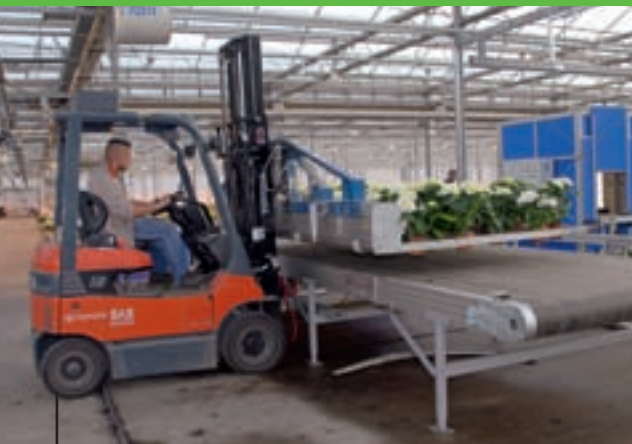
De heftruckchauffeur zet de planten op de verzamelband voor de camera...
