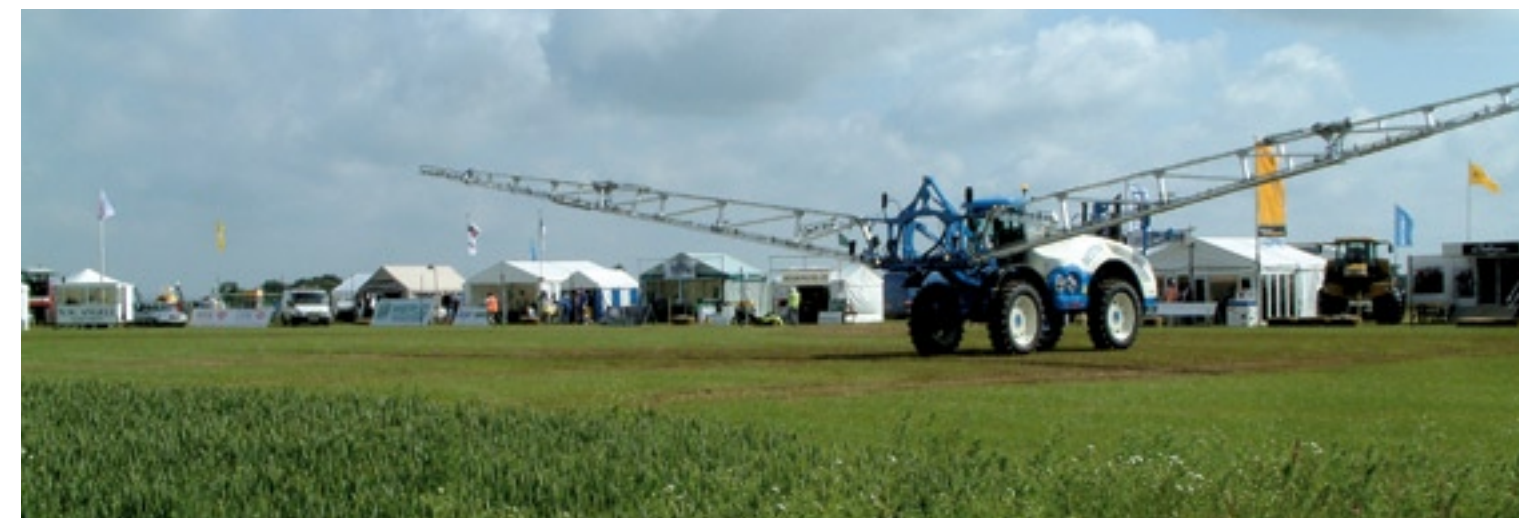
▲ De spuitboom van de Franse Matrot Maestro is geheel van aluminium. Voor voldoende draagkracht moet het aluminium dikker zijn dan een stalen uitvoering. Het voordeel van een lagere dichtheid verdwijnt daardoor voor een groot deel.
