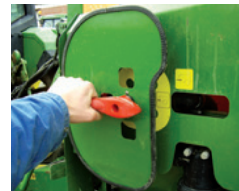
Akkerbouwer Werkman bedient de vario-schakeling van de perszijde voor spuiten, tankreiniging binnenzijde en buitenkant en het aanmaken van spuitvloeistof. De opschriften geven duidelijk de gewenste stand van de keuzekranen en hendels aan.
