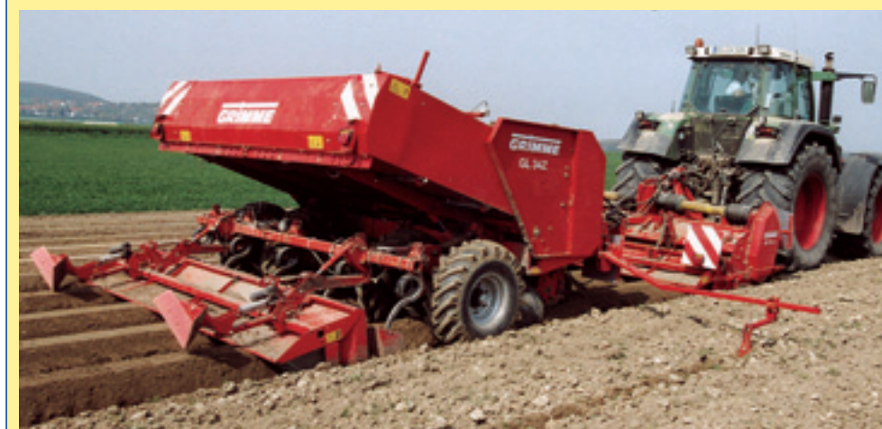
De '5 in 1' combinatie van Grimme met achtereenvolgens: grondbewerking, ruggenfrees, kunstmestdosering, poten en aanaarden.
