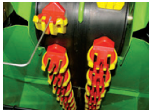
In de bekeraars kunnen inzetbekeraars worden geplaatst voor de verschillende maten.
