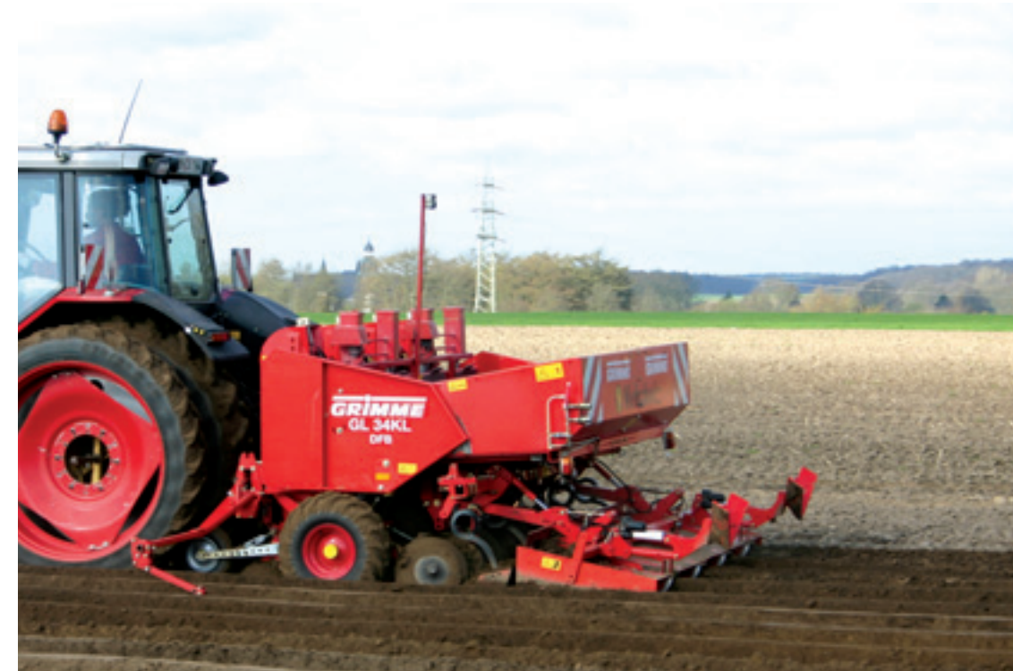
Een grote koprol en een schuine stand van het pootkanaal laat de potter bij Grimme zachtjes vallen.
