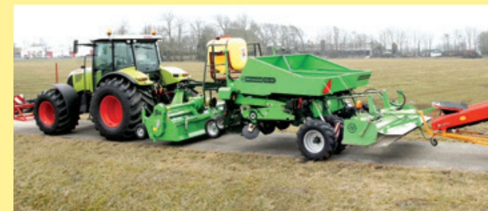
De democombinatie Miedema met achtereenvolgens: koppensnelers, frees, snarenbedpoter en aanaarden.
