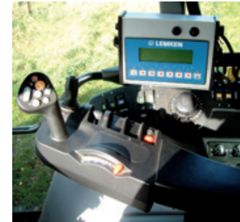
Het bedieningspaneel rechts naast de bestuurder, overzichtelijk en gemakkelijk te bedienen. De Lemken box hoort bij de bediening van de elektronisch gestuurde ploeg.
