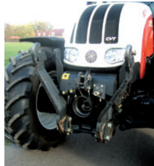
Als de frontheff niet wordt gebruikt, kunnen de hefarmen worden opgeklapt.
