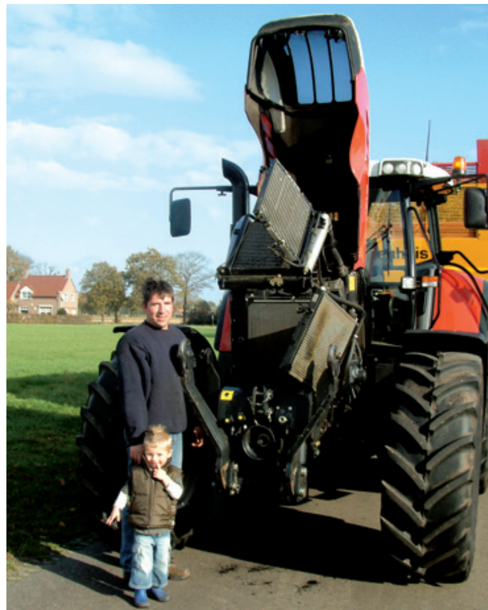
John Verberne van loonbedrijf Verberne uit Neerkant. "De Steyr 6170 is traploos en toch kan je iedereen met deze trekker wegsturen." Na het openen van de motorkap zijn alle koelelementen voor controle en reiniging op- en uitklapbaar.
