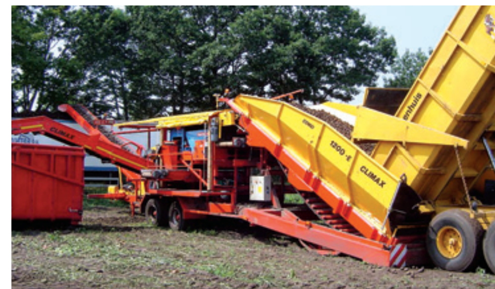
De aftakas-generator kan je gebruiken voor de aandrijving van de apparatuur bij het afland leveren van aardappelen.
