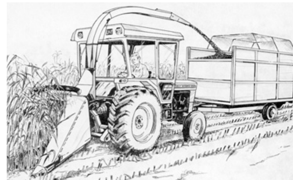
De Lely Hydro 150 met tweerijige aanbouwhakselaar. De banden op de 'vooras' zijn verwisseld om de pijlrichting naar achteren te krijgen en daarmee de aandrijvende banden goed lossend te houden.
