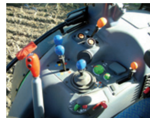
Het bedieningspaneel rechts naast de bestuurder is kleurrijk. Elke groep hendels en knoppen heeft een eigen kleur om vergissingen te voorkomen.
