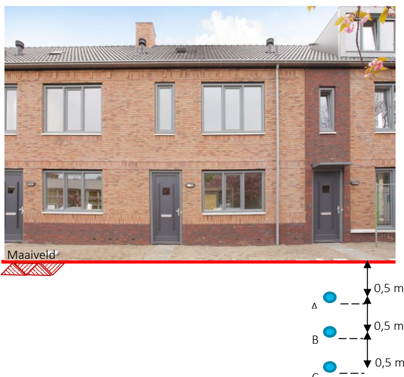
Figuur 7. Voorbeeld bodemtemperatuurmetingen op verschillende diepte in Locatie X.
