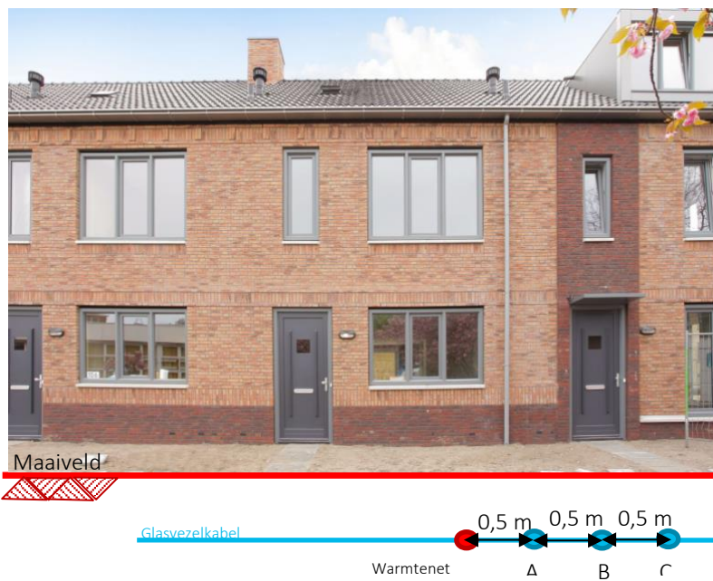
Figuur 9. Voorbeeld bodemtemperatuurmetingen op verschillende afstanden vanuit Warmtenet.
