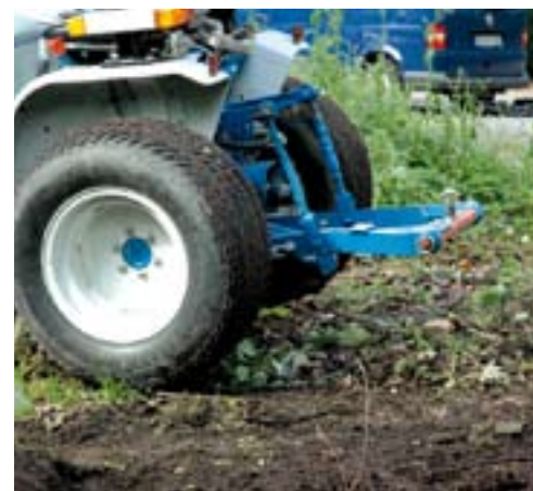
Voor serieus voorladerwerk is een contragewicht achterop onmisbaar. Zonder gewicht komen de achterwielen al snel van de grond.
