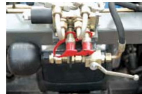
Een accumulator is soms optie en wordt alleen bij transport gebruikt. De veerwerking maakt het rijden een stuk comfortabeler en ontziet de vooras.
