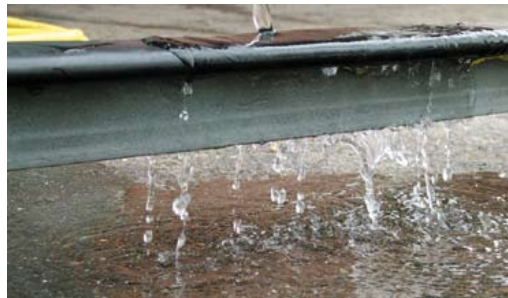
De urine, net als het water hier, loopt door de aantrekkingskrachten tussen de materialen langs het met rubber beklede stalen rooster. Dijk wil de urine opvangen in een giergootje onder het rooster.
