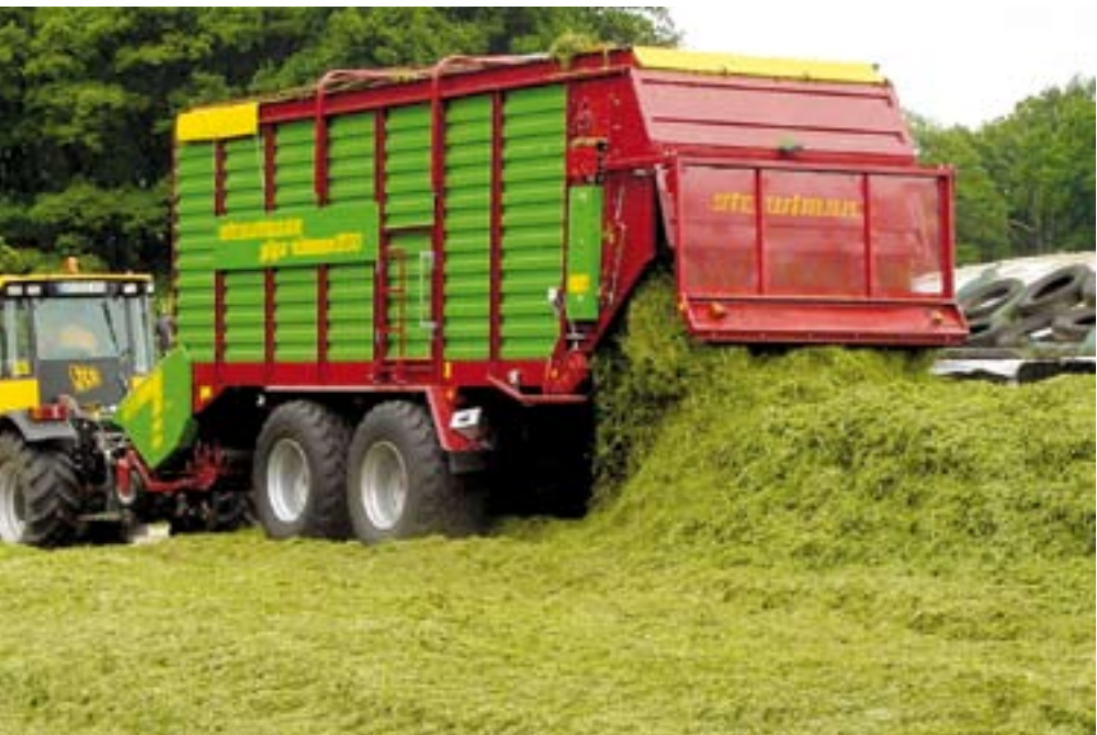
Lossen op de kuil gaat gemakkelijker als de wagen is uitgerust met doseerwalsen.
