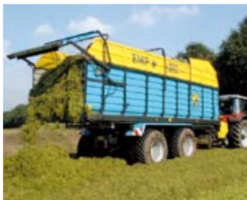
Bij de Mengele Rotobull maakt elektronica het werk gemakkelijker. Sensoren aan de voorwand schakelen de bodemketting in als er gras tegenkomt, terwijl de laadbeveiliging overbelading voorkomt.
