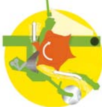
Een invoerwals met zijn kammen duwt het gras tegen de messen. Doordat ze spiraalvormig zijn gemonteerd, vraagt de opraapwagen altijd evenveel vermogen.
