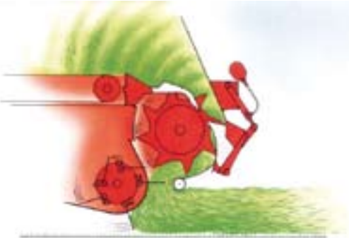
Op de wagen van Taarup is een splende opraper gemonteerd. Daardoor kan de invoerwals andersom draaien. Volgens de fabrikant kan de wals daardoor meer kracht zetten, wat tot een betere vulling van de wagen leidt.
