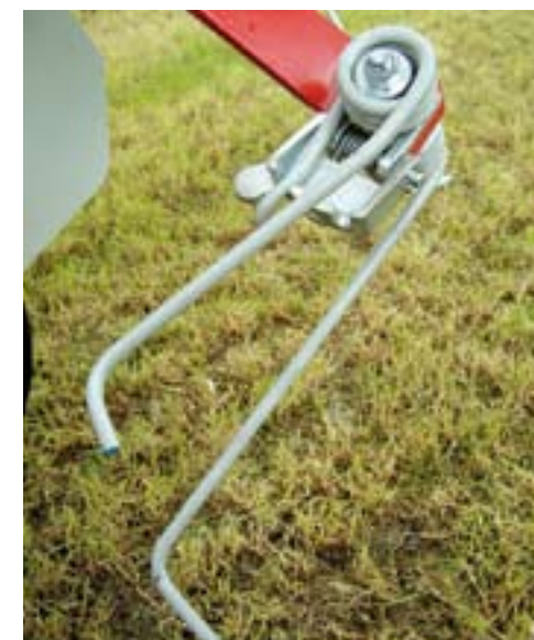
De haakband van Lely moet het gras van de grond schrapen. Bovenaan het blokje waarmee de tanden versteld worden om de kant te schudden.
