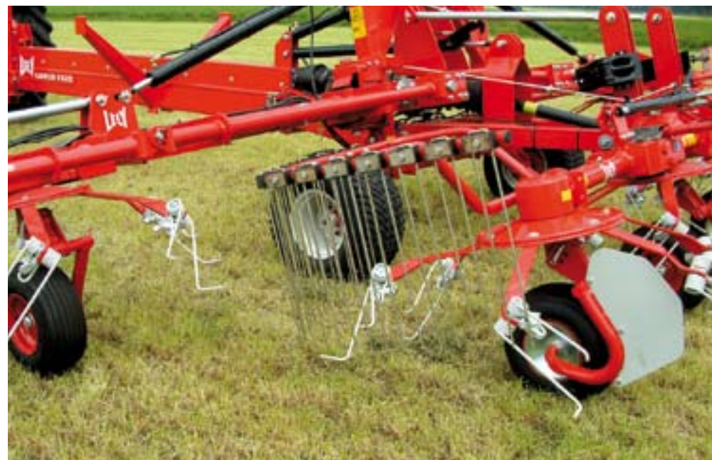
Een korf van tanden beschermt de buitenste rotoren en de wielen van de achterste machine tegen het gras dat de voorste rotoren naar achteren gooit.
