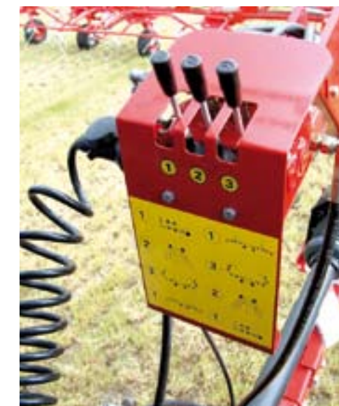
Het in- en uitklappen doe je met de drie hendels op de bok van de machine. Ze zitten iets te ver buiten het bereik van de chauffeur.
