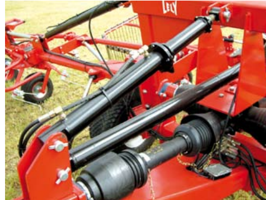
De werkdiepte bepaal je met deze spindel op de hydraulische cilinder, die dienst doet als aanslag.
