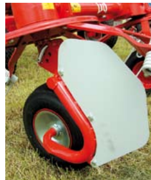
Het AntiWikkelSysteem dat Lely bedacht. Het gras glijdt van de arm af en kan door de plaat aan de arm er niet omheen slaan.
