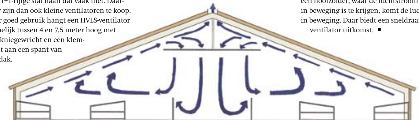
Een HVLS-ventilator duwt de lucht onder de ventilator omlaag, waarna het zich over de voergang naar de buitenmuren verplaatst.
