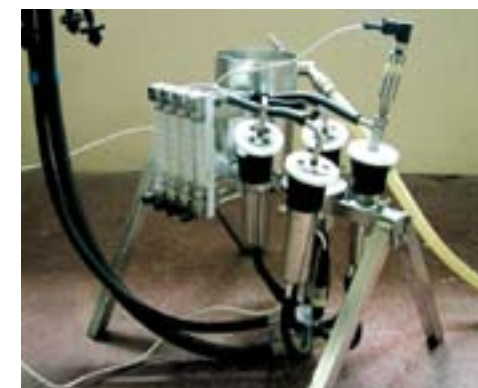
Om ook in melkstallen te kunnen meten, ontwikkelde Moorepark deze simulator. Tijdens het melken hing een van de melkstellen aan het apparaat waarna op verschillende plaatsen het vacuümniveau in het stel werd gemeten.
