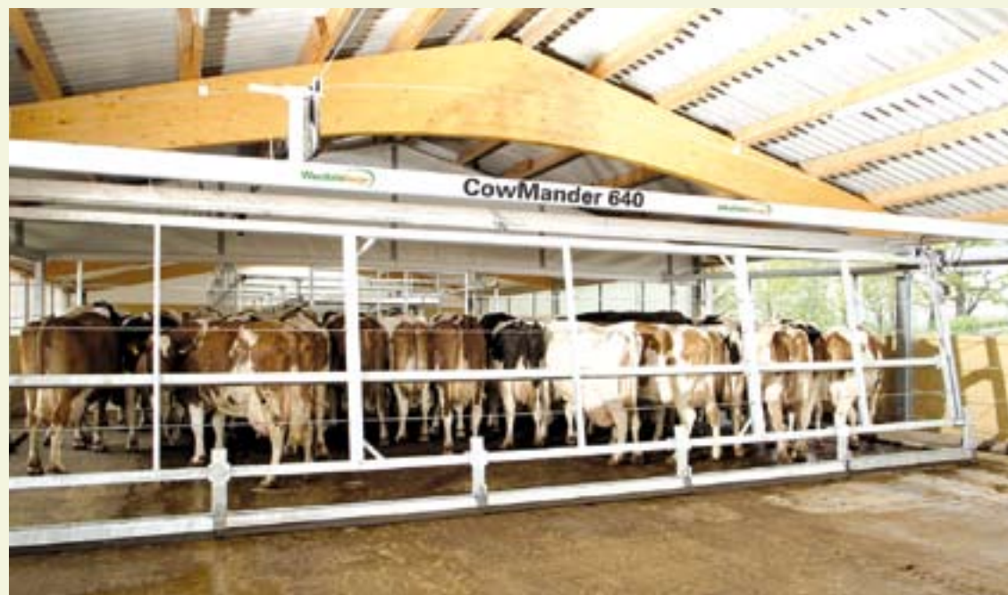
Een solide hek voor grote zelfstandige wachtruimten is er vanaf 15.000 euro. Ook zij zijn uit te rusten met een mestschuif en een sproei-installatie, zodat hij de hele wachtruimte schoonmaakt, terwijl hij naar voren beweegt. Deze CowMander 640 van WestfaliaSurge kan tot 11 meter breedte en een lengte van 35 meter overbruggen. Kosten: 35.000 euro.
