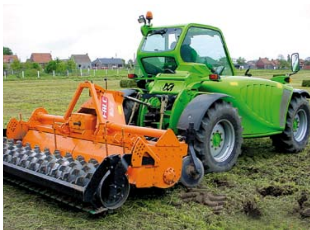
Een verreiker met aftakas is ook geschikt voor veldwerk en kan een trekker vervangen.
