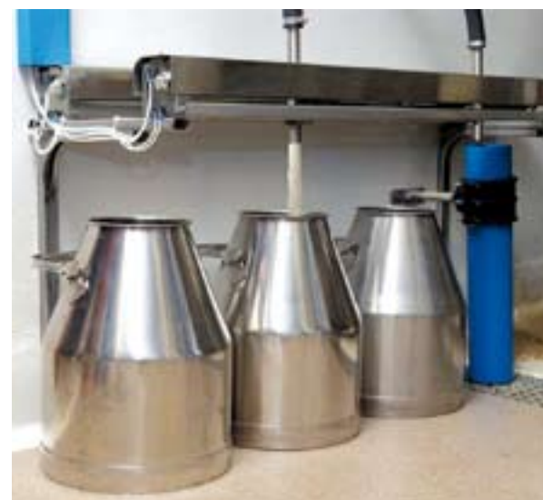
Het VMS kan vier verschillende soorten melk scheiden.
