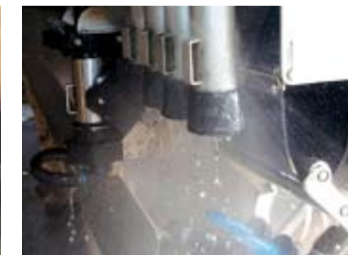
Na elke melking worden de tepelbekers grondig gereinigd.
