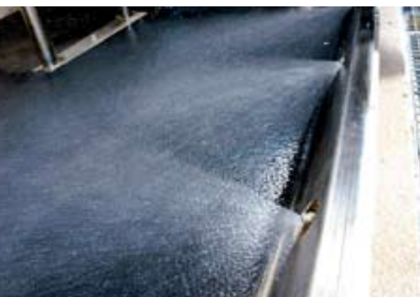
De antislip rubbervloer wordt na een instelbaar aantal koeien gereinigd.
