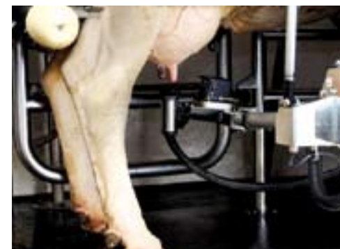
De voorbehandelbeker reinigt de spenen met water en lucht.
