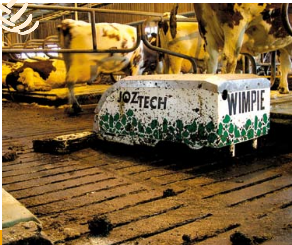
De JOZtech uitmestrobot rijdt met een snelheid van 4 m per minuut tussen de koeien door en schuift de vloer schoon.
