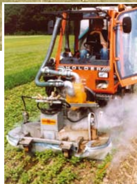
Links: Branden werkte op gele mosterd duidelijk het zuinigst en snelst. Maar niet op gras. Verder gaf branden een sneller grasherstel dan heet water en heet schuim, zodat er sneller een vervolgbestrijding nodig zal zijn. Rechts: Op gras verbruikte de heetwatermachine het minste brandstof en werkte ook het snelst.
