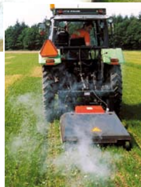
Links: Branden werkte op gele mosterd duidelijk het zuinigst en snelst. Maar niet op gras. Verder gaf branden een sneller grasherstel dan heet water en heet schuim, zodat er sneller een vervolgbestrijding nodig zal zijn. Rechts: Op gras verbruikte de heetwatermachine het minste brandstof en werkte ook het snelst.
