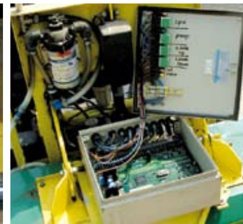
De sensoren (foto links) reageren op fluorescentie van het bladgroen dat door rood licht wordt aangestraald. Deze signalen worden verzonden naar de centrale computer (foto rechts) die de spuitnozzles naast de sensoren open zet.
