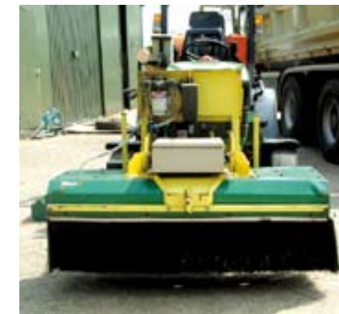
Kunststof borstels schermen de sensoren en spuitnozzles rondom af.
