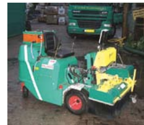
De Weed-IT van M. van der Spek Hoveniersbedrijf is op een 'rolmops' geplaatst. Deze zeer compacte en wendbare machine wordt onder meer ingezet op NS-perrons die per lift bereikt moeten worden.
