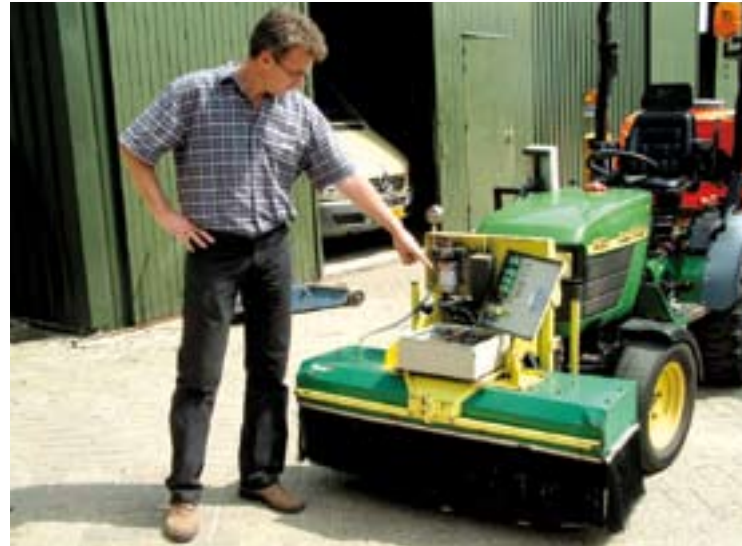
Rob Luyk wijst de pomp aan. Deze heeft een capaciteit van 6,5 l/min. Wanneer je niet spuit, circuleert de vloeistof terug naar de pomp. Er zit geen retouraansluiting naar de tank.
