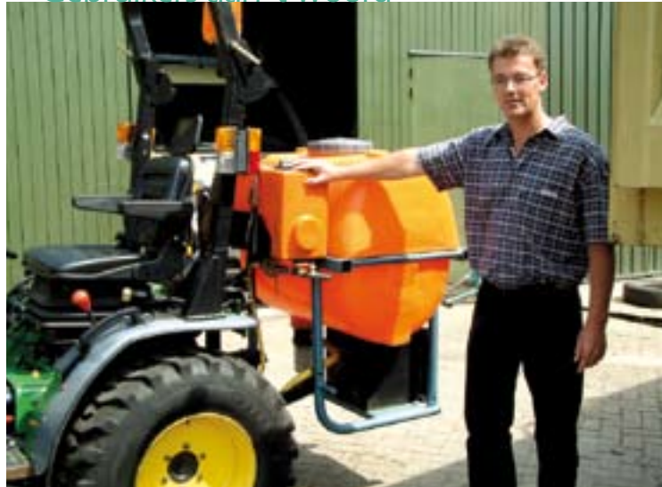
Rob Luyk van Huib van den Hoven Plantsoenwerken bij de tanks. De voorste tank bevat schoon water, de achterste een oplossing van Roundup Evolution.
