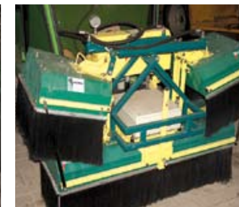
De Weed-IT van G. Bras en Zoon Fijnaart is uitgerust met twee opklapbare zijden. Deze zijn op maat gemaakt om de trottoirs te spuiten terwijl het voertuig in de goot rijdt.
