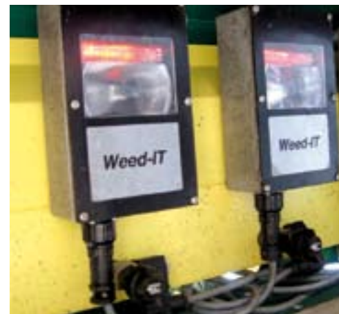
De sensoren (foto links) reageren op fluorescentie van het bladgroen dat door rood licht wordt aangestraald. Deze signalen worden verzonden naar de centrale computer (foto rechts) die de spuitnozzles naast de sensoren open zet.
