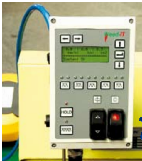
De bedieningskast van de Weed-IT. De knoppen zijn logisch en overzichtelijk geplaatst. De instellingen zijn duidelijk afleesbaar op het scherm.
