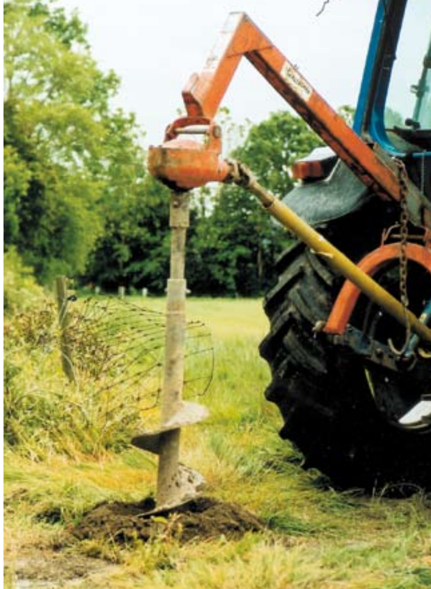
Een knappe boor in de driepunt is te koop voor zo'n 2.400 euro. Voor zo'n 550 euro meerprijs kan die ook hydraulisch zwenken. Een handige optie die nauwkeurig plaatsen een stuk makkelijker maakt. Nog handiger is een boorunit op een minishovel of schranklader.
