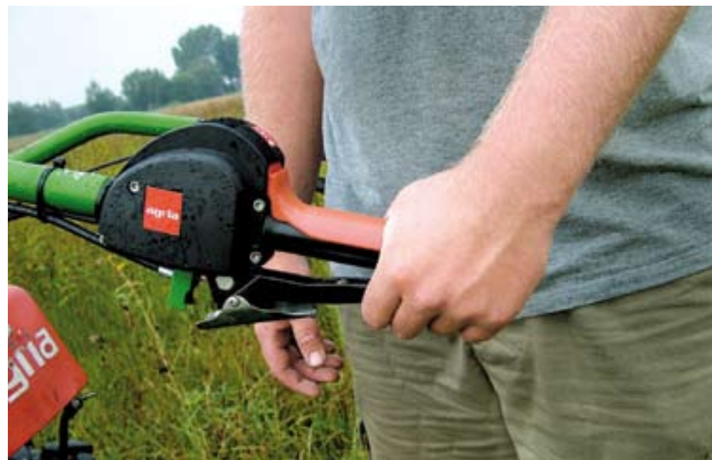
Door de koppelingshendel en de dodemansknop in te knijpen, kun je rijden met de machine.
