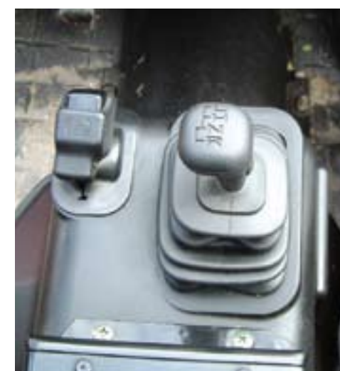
Opvallend is de kleine handrem links naast de versnellingspook.
