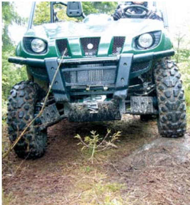
De onafhankelijke wielophanging via een dubbele A-arm constructie zorgt voor optimale aanpassing aan het terrein, zowel de voorwielen... als de achterwielen.
