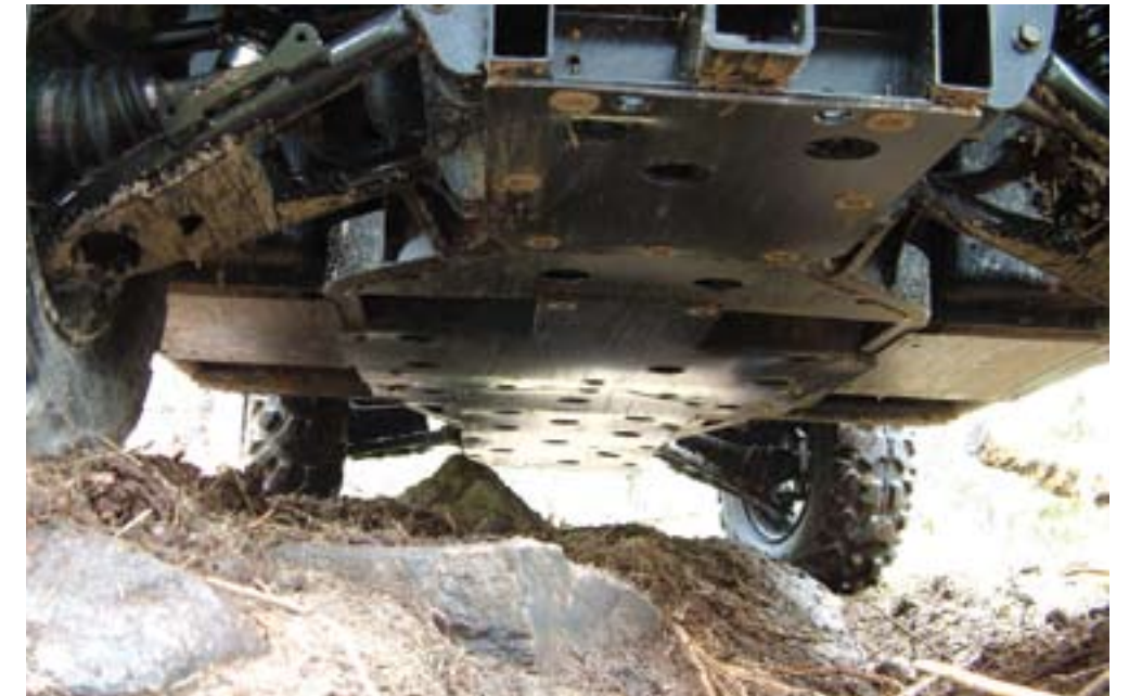
Een bodemplaat beschermt de onderkant.
