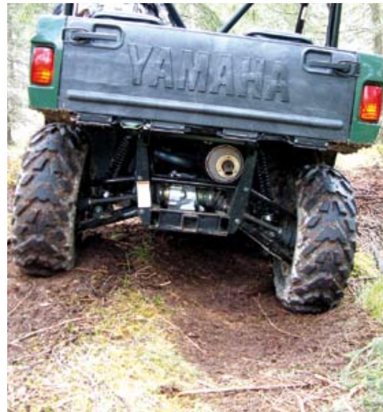
De onafhankelijke wielophanging via een dubbele A-arm constructie zorgt voor optimale aanpassing aan het terrein, zowel de voorwielen... als de achterwielen.
