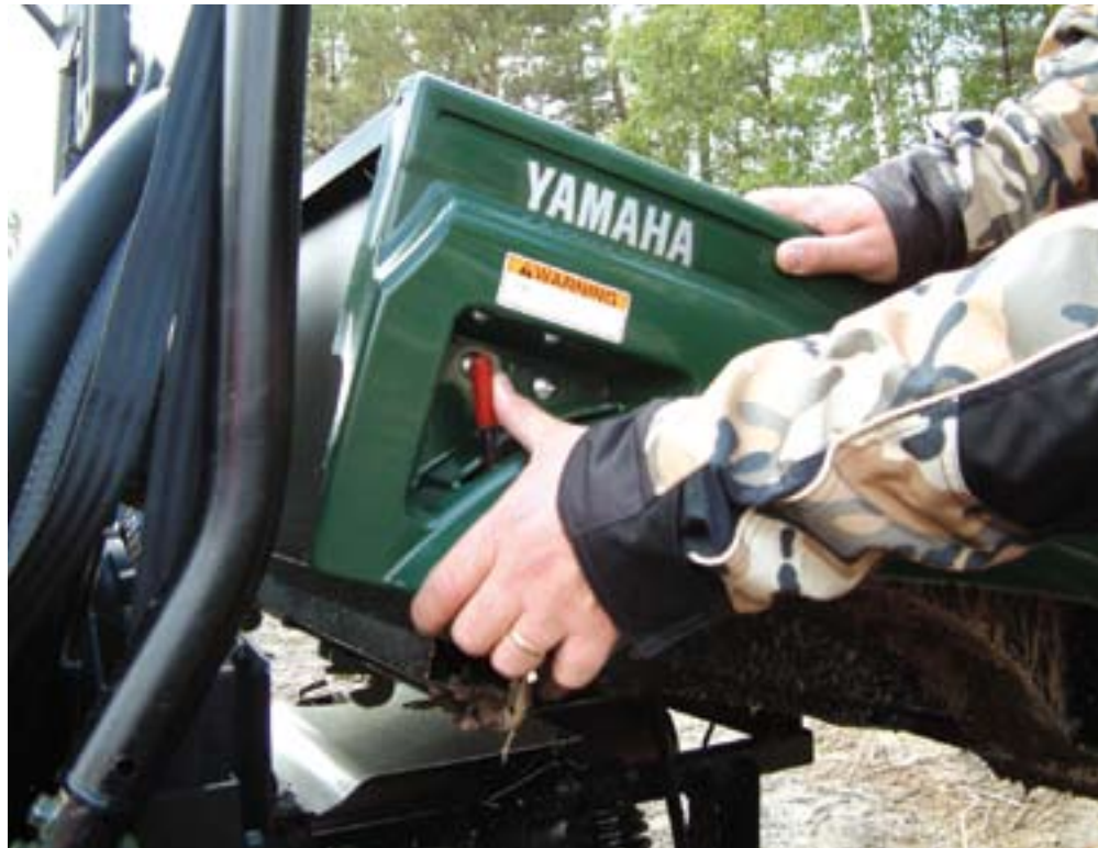
De laadbak kan je handmatig kippen door een hendel aan de bestuurderskant.
