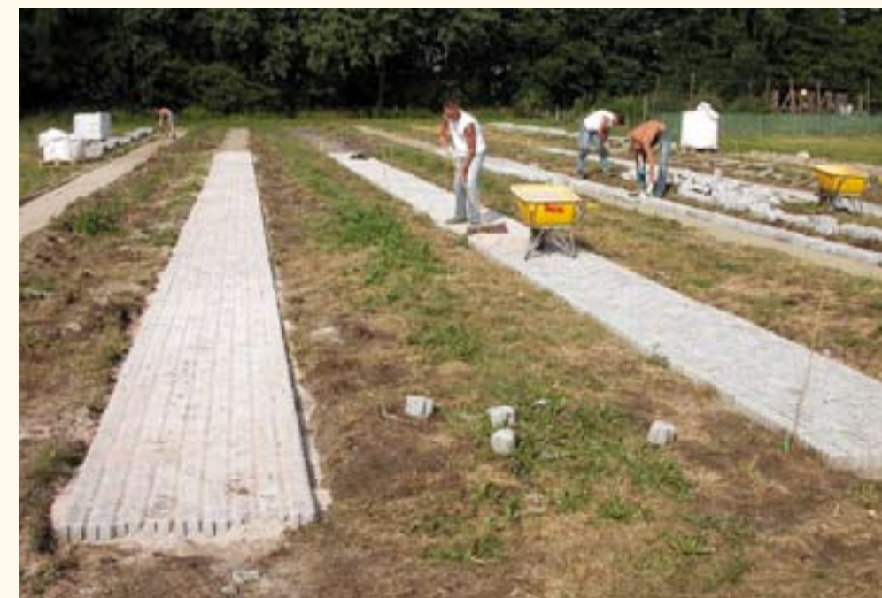
Onkruidwerende voegen kunnen de noodzaak tot onkruid bestrijden verkleinen, maar zijn duurder bij aanleg. DOB test deze voegen.
