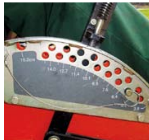
Het instellen van de maaihoogte is eenvoudig. Met een ijzeren pen stel je de hoogte in, de hefstaang rust vervolgens tegen de pen.
