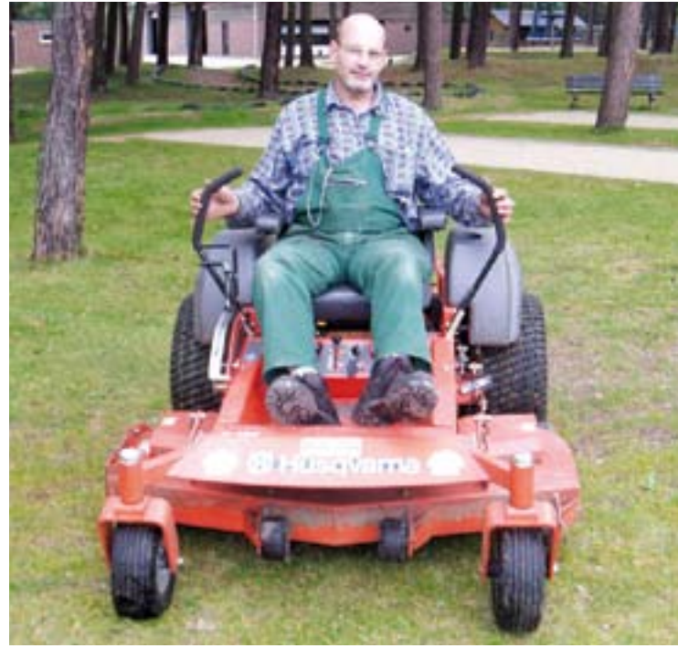
Wanneer beide stuurknuppels naar buiten staan, kun je niet rijden met de maaier.
