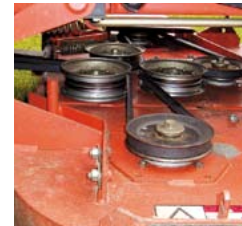
Het maaidek is degelijk uitgevoerd. De steunwielen zijn in hoogte verstelbaar. De aandrijving van de drie messen gebeurt met behulp van een V-snaar.
