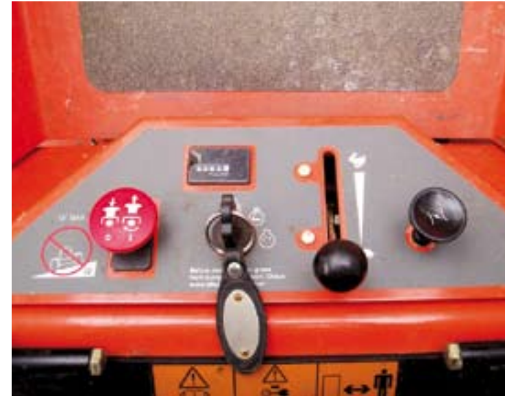
Op het bedieningspaneel zijn alle functies voor het starten van de machine en het in werking zetten van de maaier aanwezig.
