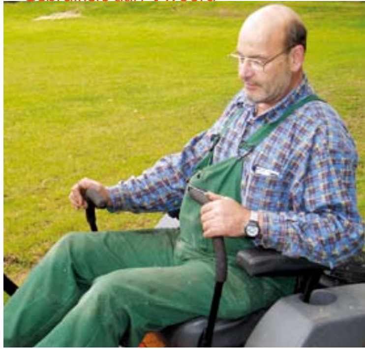
Paul Smits laat zien hoe je kort kunt draaien. De rechterstuurknuppel staat naar voor en de linker naar achter: de maaier draait kort linksom.
