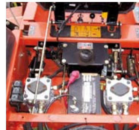
Het kloppende hart van de maaier. In het midden zit de accu, links en rechts hiervan zijn de hydromotoren van beide wielen geplaatst. Dit alles zit onder de zitting.
