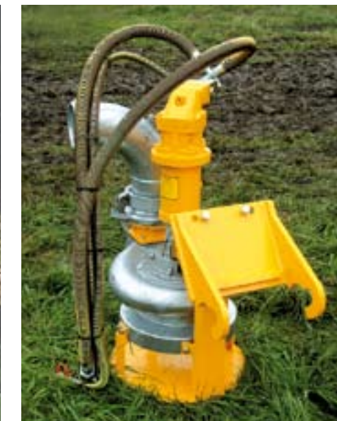
Met de Herder centrifugaal waterpomp aan de hydraulische giek kan je snel teveel water wegpompen.
