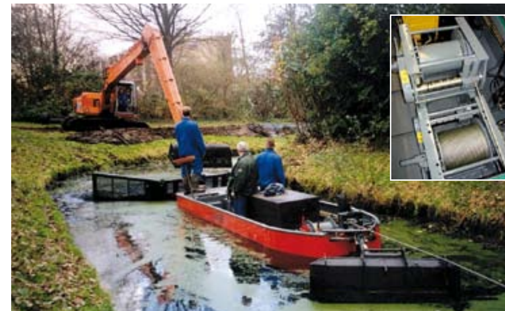
Conver BOB baggeropduwboot. Door nauwgezette geleiding komt de 300 m lange kabel precies aaneengesloten op de trommel.
