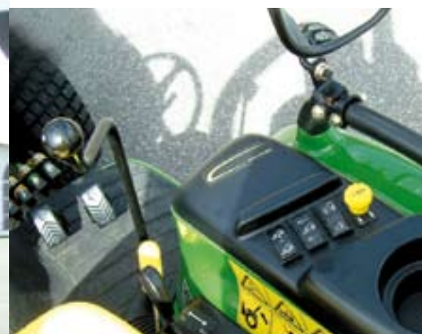
Eenvoudige bedieningsconsole aan de rechterkant: Hendel voor bediening voorlader, hef en drie knoppen (naast de gele knop van de aftakas) voor: Cruise Control, SpeedMatch, MotionMatch.
