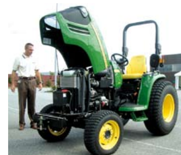
Het kleine onderhoud is gemakkelijk. De motorkap kan helemaal omhoog en de eenvoudige servicepunten zitten aan één kant: olie, koelvloeistof, filter.
