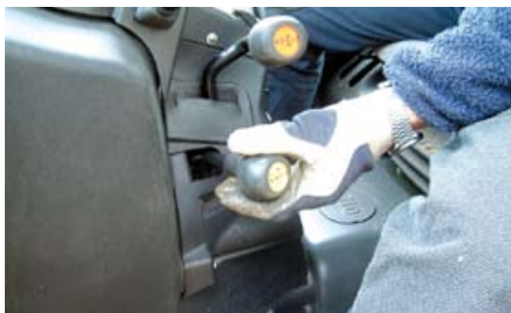
Mario Visch schakelt de aftakas in. Dit gebeurt in twee stappen: eerst kies je het gewenste toerental en vervolgens schakel je hem in met de gele hendel onder het stuur.
