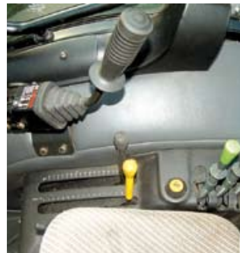
Rechts naast de bestuurder zitten de bediening van de hydrauliek, de hef en de inschakeling van het differentieel. De kruishendel is voor de bediening van de voorlader.
