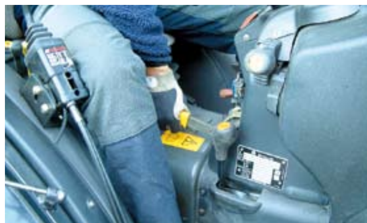
Mario Visch schakelt de aftakas in. Dit gebeurt in twee stappen: eerst kies je het gewenste toerental en vervolgens schakel je hem in met de gele hendel onder het stuur.
