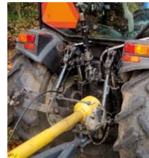
De hef heeft een hefvermogen van 1.200 kg (cat. 1). De aftakas kan op 540, 540E en rijafhankelijk worden ingesteld.
