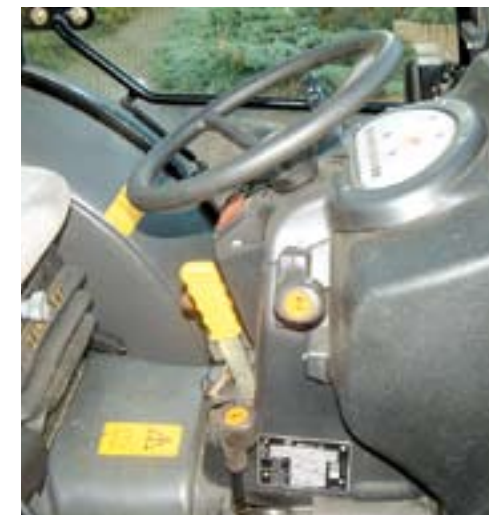
Rechtsonder het stuur vind je de groepenpook (onder) en versnellingshendel.
