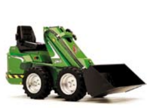
Schrankladers zijn handig en wendbaar. Maar ook hierbinnen heb je weer hele kleine voor de allerkleinste ruimten. Zoals de Dingo van Toro, de Avant en de MultiOne. Ze zijn niet alleen een veredelde grondscheper, aan de arm kunnen diverse werktuigen van grondboor, sleuvengraver tot rolbezem.
