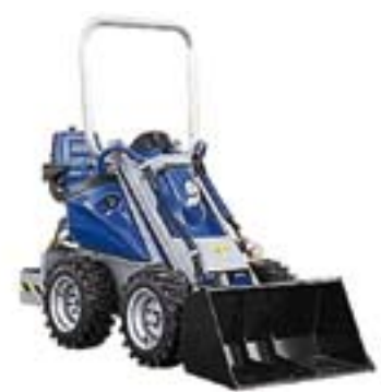
Schrankladers zijn handig en wendbaar. Maar ook hierbinnen heb je weer hele kleine voor de allerkleinste ruimten. Zoals de Dingo van Toro, de Avant en de MultiOne. Ze zijn niet alleen een veredelde grondscheper, aan de arm kunnen diverse werktuigen van grondboor, sleuvengraver tot rolbezem.
