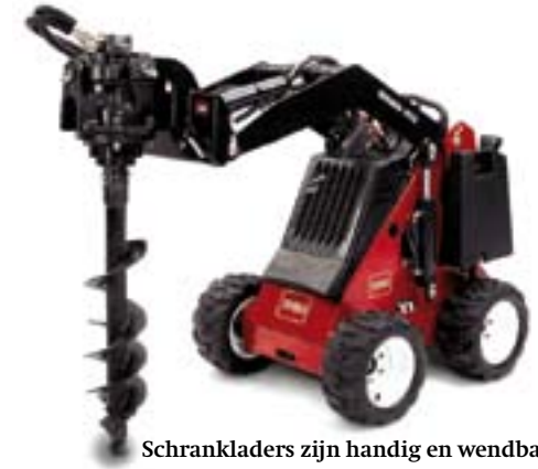
Schrankladers zijn handig en wendbaar. Maar ook hierbinnen heb je weer hele kleine voor de allerkleinste ruimten. Zoals de Dingo van Toro, de Avant en de MultiOne. Ze zijn niet alleen een veredelde grondscheper, aan de arm kunnen diverse werktuigen van grondboor, sleuvengraver tot rolbezem.
