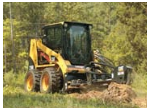
Caterpillar schrankladers hebben een anti-vastloopsysteem. Dit zorgt ervoor dat de motor bij maximum koppel niet afslaat.
